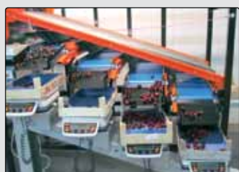
Μηχανικό διαλογητήριο με βάση το βάρος PERFECT: MGS Mechanical sorting machine by weight PERFECT: MGS
