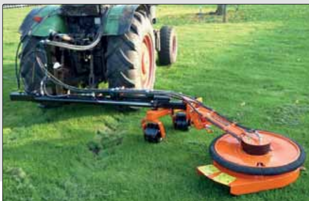
Ρόδα Στελεχοκόπτη SZS - 600 Mower Wheel SZS - 600
