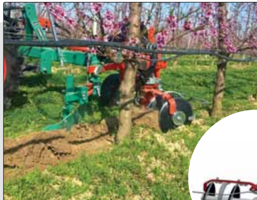
Δισκοσβάρνα με αισθητήρα Disk Hoe with feeler
