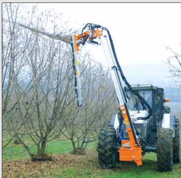
Κορυφολόγηση για δένδρα ORP Trimmer for orchards ORP
