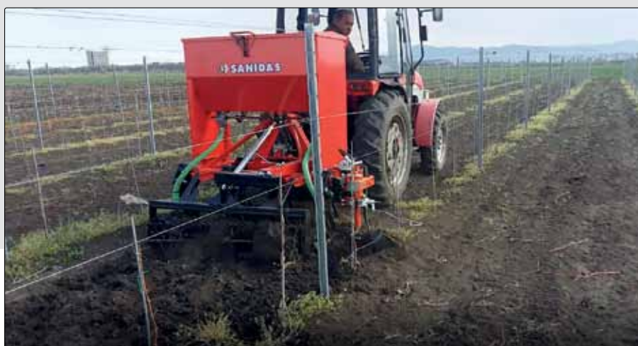
Υπεδαφοκαλλιεργητής με Λιπασματοδιανομέα και τσαπάκι SRT - A - L Subsoiler with Fertilizer and under weeder SRT - A - L
