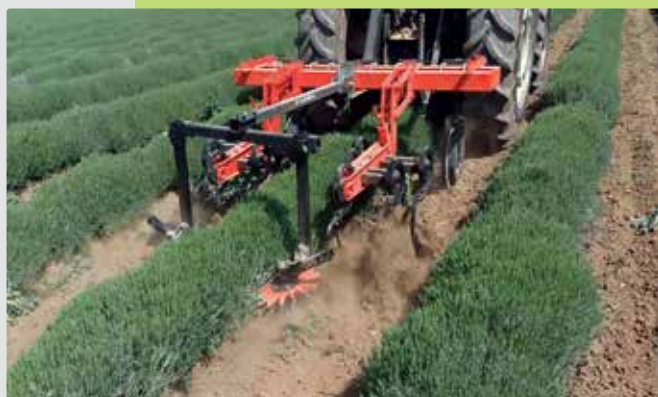
Καλλιεργητής SKAK - 1 με ρυθμιζόμενα δακτυλοσκαλιστήρια \varnothing 370mm Weeding machine SKAK - 1 with adjustable fingerweeder \varnothing 370mm
