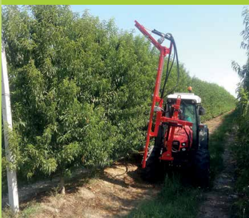
Κορυφολόγηση για δένδρα SKOT-M/D με τηλεσκοπική κολώνα Trimmer for orchards SKOT-M/D with telescopic frame
