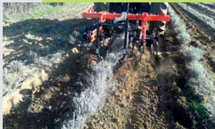
Καλλιεργητής SKAK - 1 με standard δακτυλοσκαλιστήρια \varnothing 370mm Weeding machine SKAK - 1 with standard fingerweeder \varnothing 370mm
