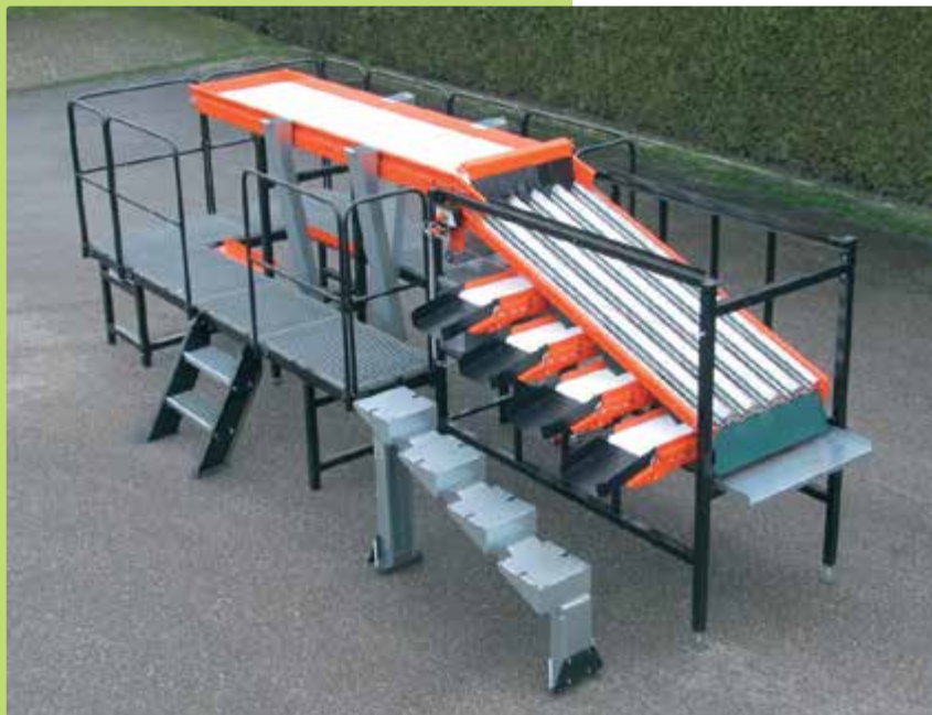
Μηχανικό Διαλογητήριο κερασιών με βάση τη διάμετρο PERFECT: CGM Mechanical Sorting machine by diameter for cherries PERFECT: CGM
