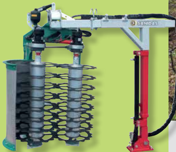
Προκλάδεμα VARIO σε κολώνα SK Pre-pruner VSL07P on frame SK
